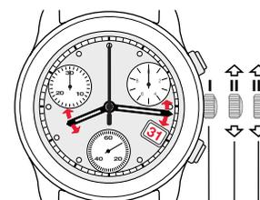
Regolazione della lancetta delle ore e regolazione della data ogni passaggio a mezzanotte
